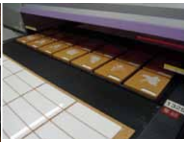
「JFX-1631」の大型フラットベッドに複数の室名札を面付け、一挙にUV印刷を行う。
