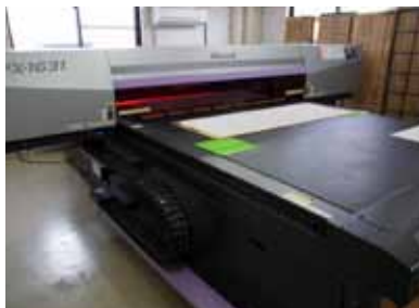
「JFX-1631」の大型フラットベッドに複数の室名札を面付け、一挙にUV印刷を行う。
